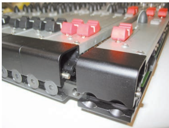
Mittels Inbusschrauben und Gewinde-Inlays werden die einzelnen Module von „Arthur“ zu einer Einheit verbunden
