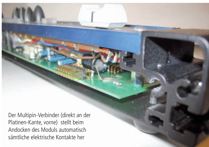
Mittels Inbusschrauben und Gewinde-Inlays werden die einzelnen Module von „Arthur“ zu einer Einheit verbunden
